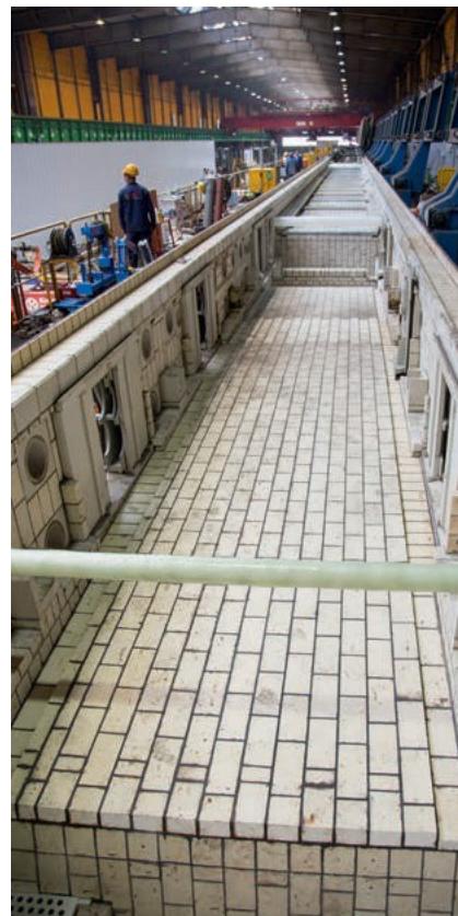
Zbiornik do wytrawiania wyłożony cegłą
