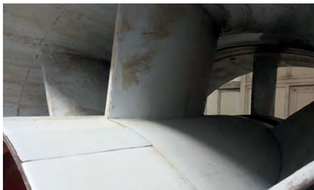
REMAFLON jako wykładzina antyadhezyjna w wentylatorze spalin
