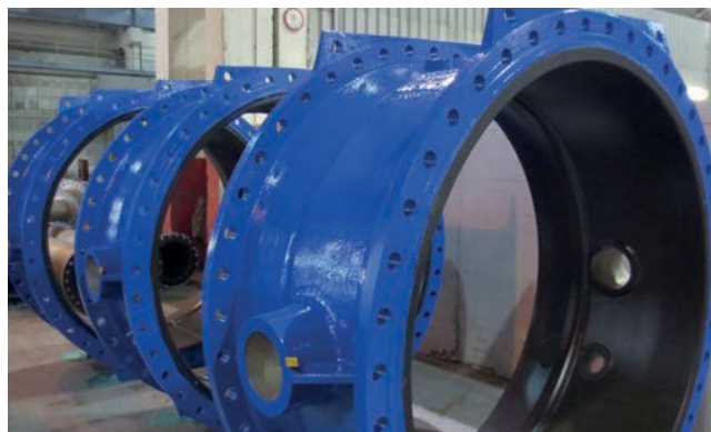
Rura przepływomierza wyłożona gumą
